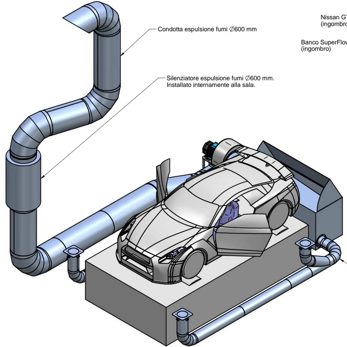
Condotta espulsione fumi Ø600 mm
