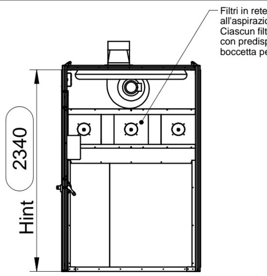
Filtri in rete metallica, lavabili, all'aspirazione del ventilatore di estrazione. Ciascun filtro dotato di serranda di chiusura con predisposizione per installare una bocchetta per aspirazione localizzata.
