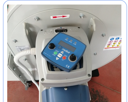
Fig. 2: Motoinverter con telecomando wireless
